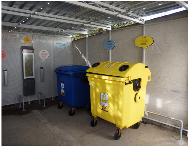
kontajnerové stanovište je okrem smetných nádob nádob vybavené aj osvetlením, informačnými tabuľkami v tvare bublín a ochrannými kovovými zábranami pri stenách a olejťe (pokiaľ má olejťeka horizontálny tvar zábrany netreba)
